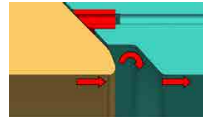
Разработанная новая конструкция. Загрязнение не откладывается
