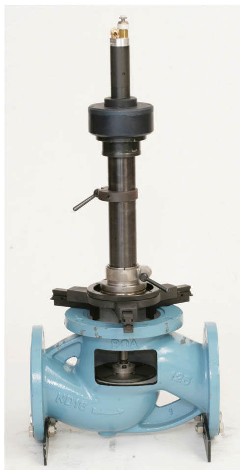
TSV-150 с зажимным патроном (с пневмоприводом)
