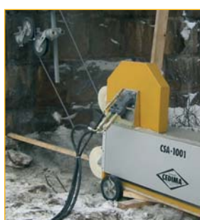
Канатный автомат CSA-1001 при вертикальной резке
