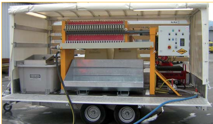
слева: буферная ванна с сеткой; в центре сверху: фильтрующий элемент; в центре внизу: лоток под отходы
