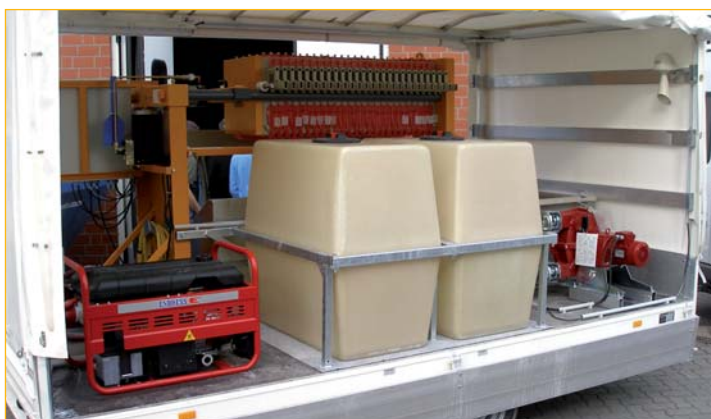
слева: генератор тока, баки очищенной воды, шламовый насос
