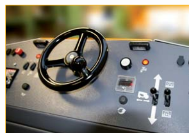
эргономичное, удобное рабочее место с цифровым указателем глубины резки
