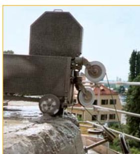
Канатный автомат CSA-1001 при горизонтальной резке
