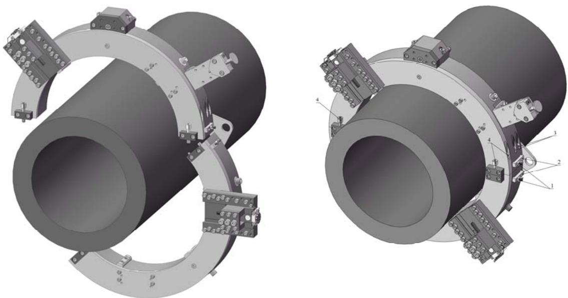
Рис.13. Монтаж трубореза на трубе
