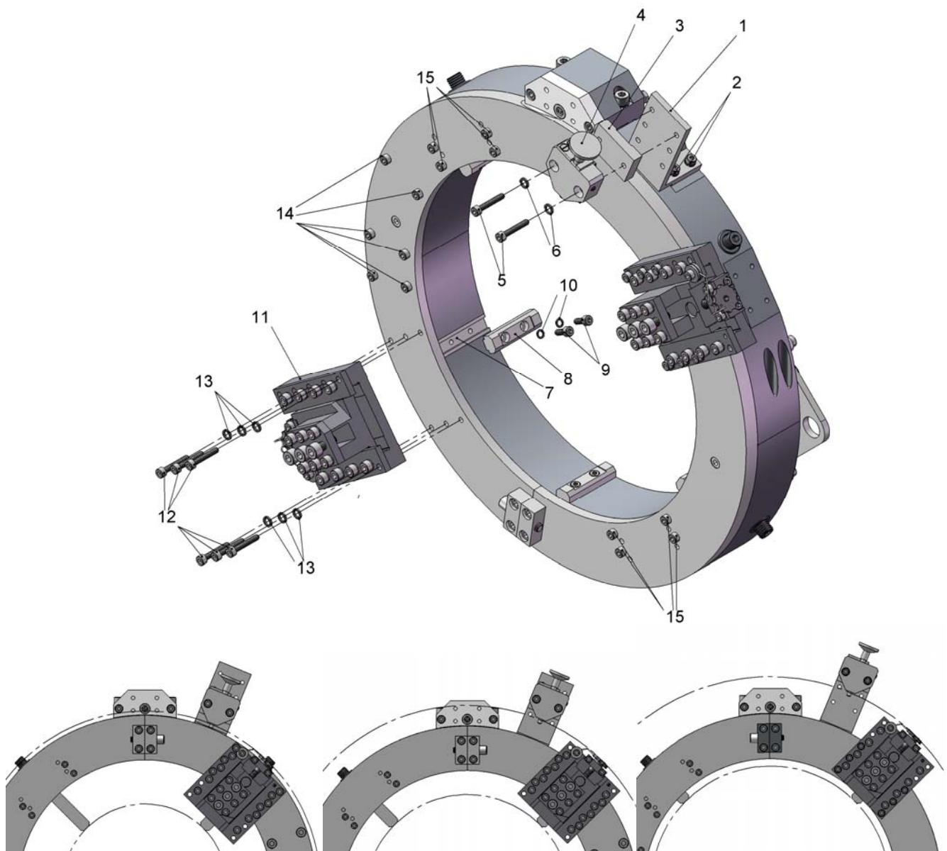
Рис.10. Установка удлиненных отрезных суппортов
