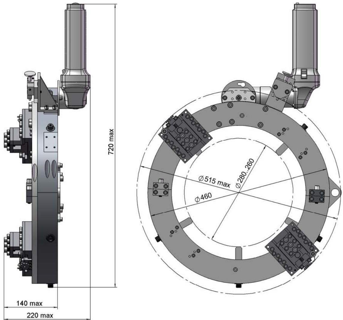
Рис.2 Труборез TPP-325 (с установленными удлиненными суппортами, диапазон 230 < D<sub>нап</sub> < 280 мм)
