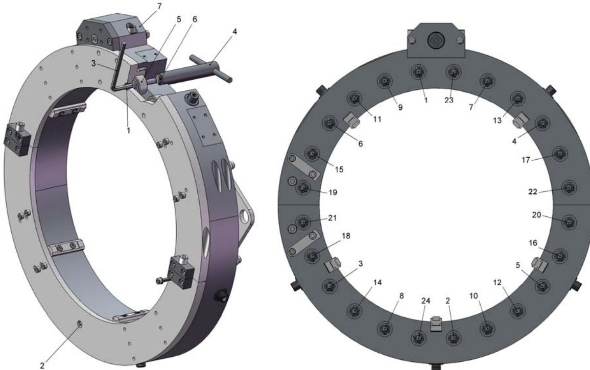
Рис.22. Регулировка подшипников рамы
