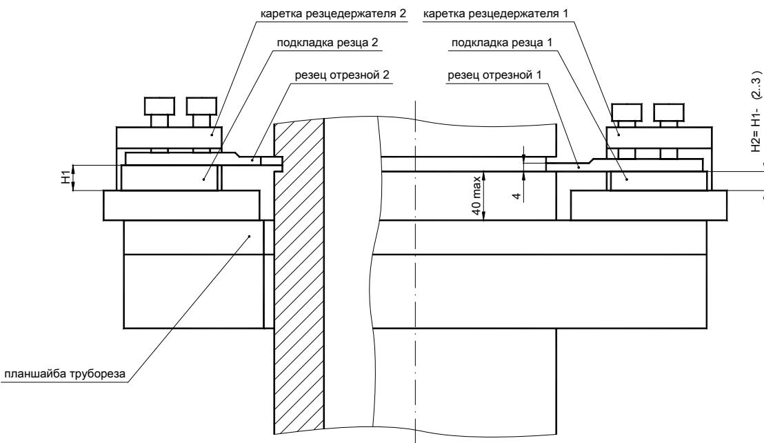
Рис.17. Отрезка двумя резцами. Вариант 2
