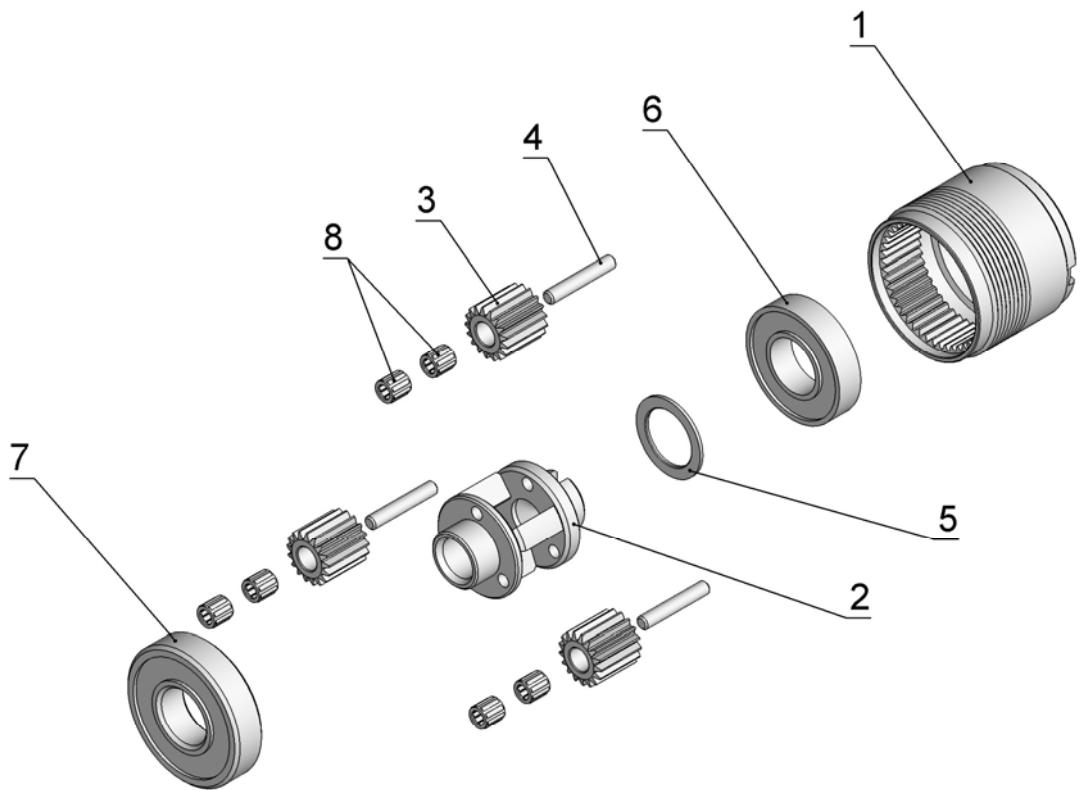
Рис. 10. Редуктор планетарный второй ступени в сборе
