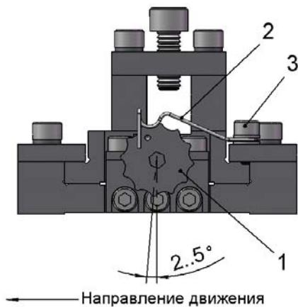
Рис.11. Проверка установки пружины фиксатора звездочки отрезного суппорта
