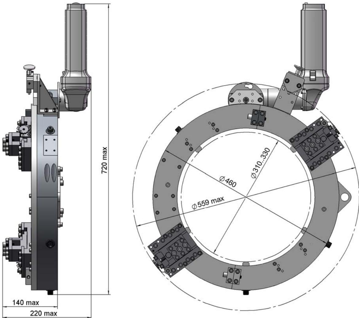
Рис.3 Труборез TPP-325 (с установленными удлиненными суппортами, диапазон 230 < D<sub>нар</sub> < 280 мм)
