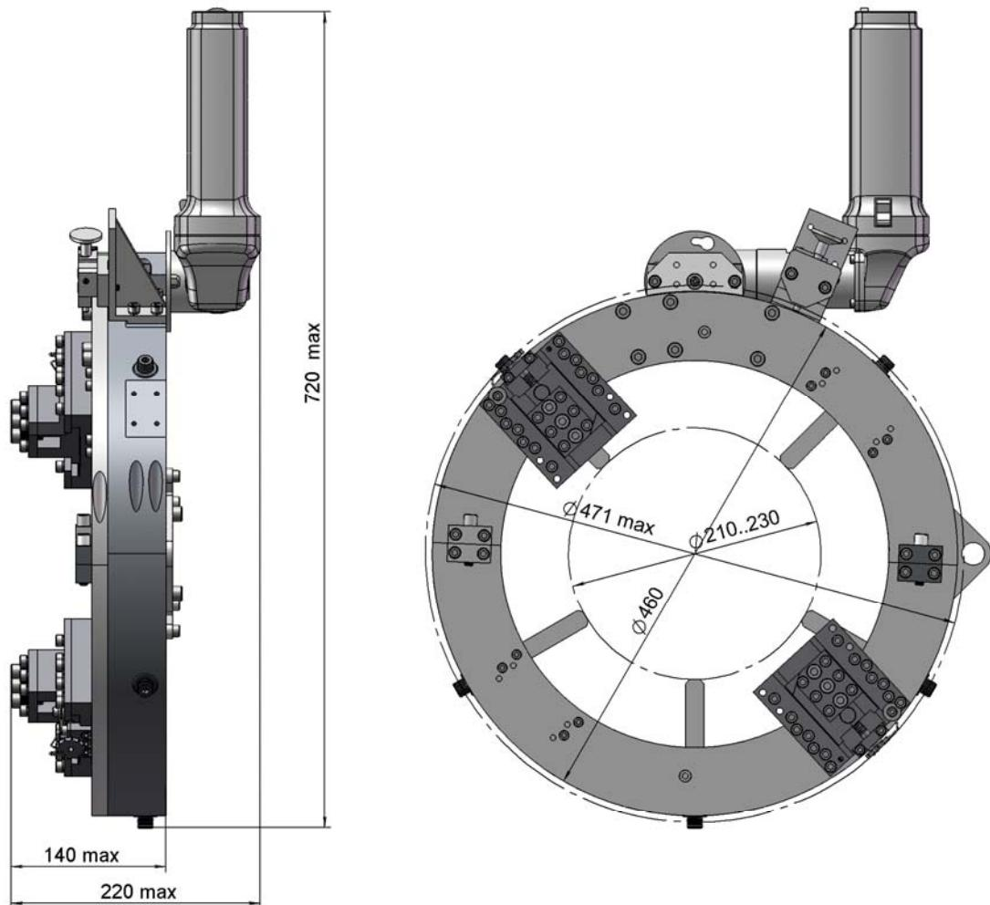
Рис.1 Труборез TPP-325 (с установленными удлиненными суппортами, диапазон D<sub>нап</sub> < 230 мм)
