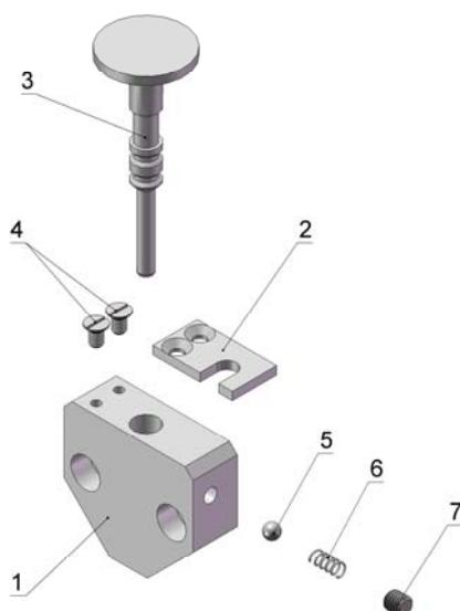
Рис. 8. Механизм замыкателя автоподачи отрезного суппорта в сборе
