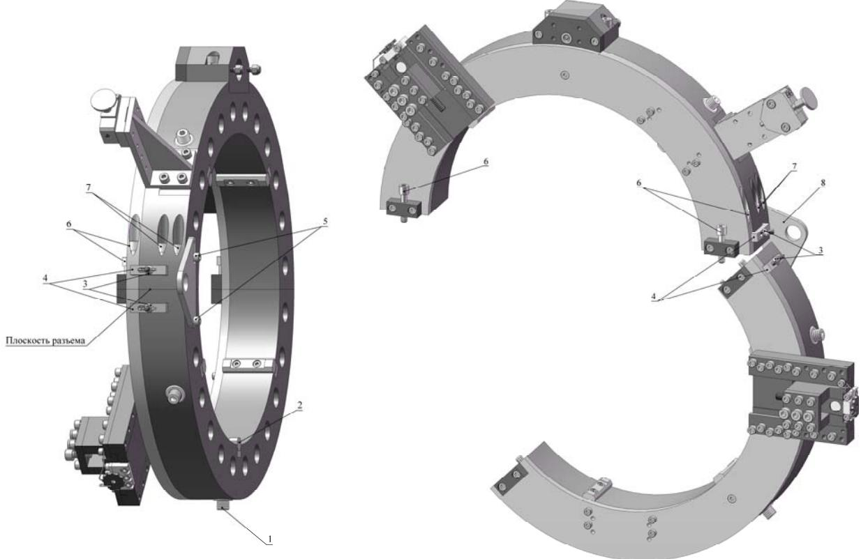
Рис.12. Разъем трубореза на две половины
