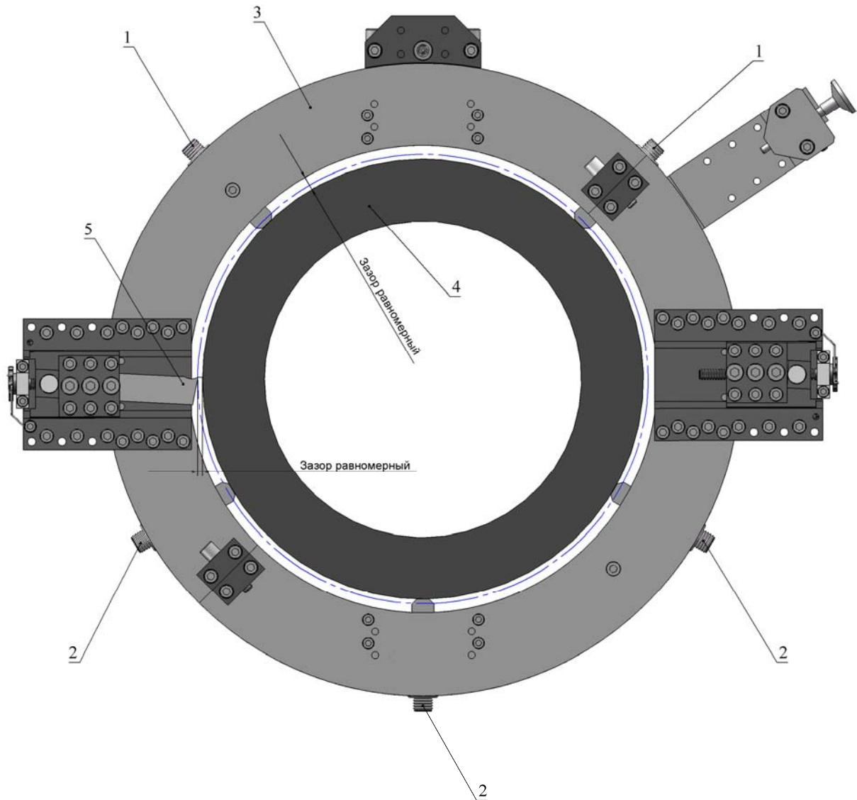
Рис.14. Центровка и закрепление трубореза на трубе
