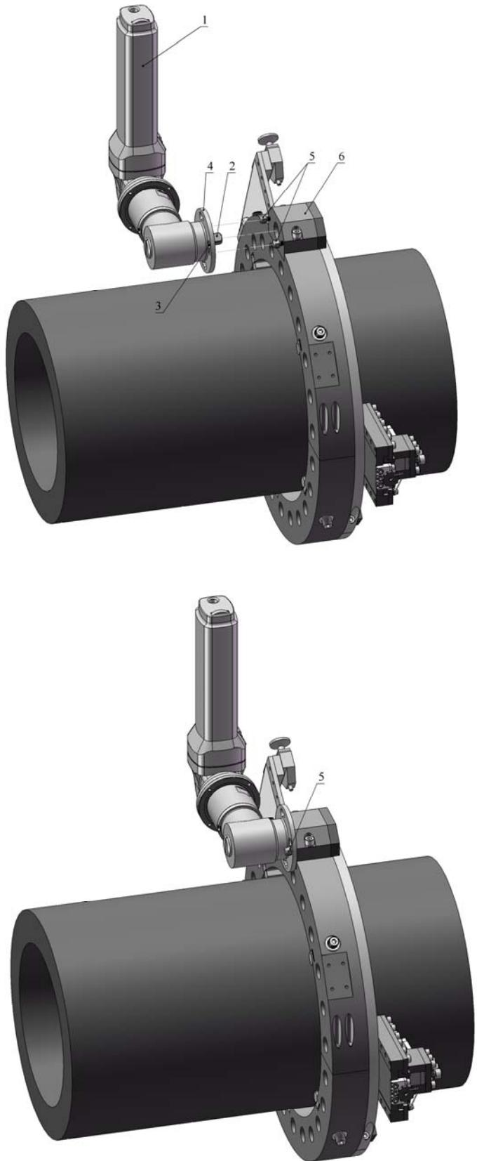
Рис.15. Присоединение электропривода к труборезу
