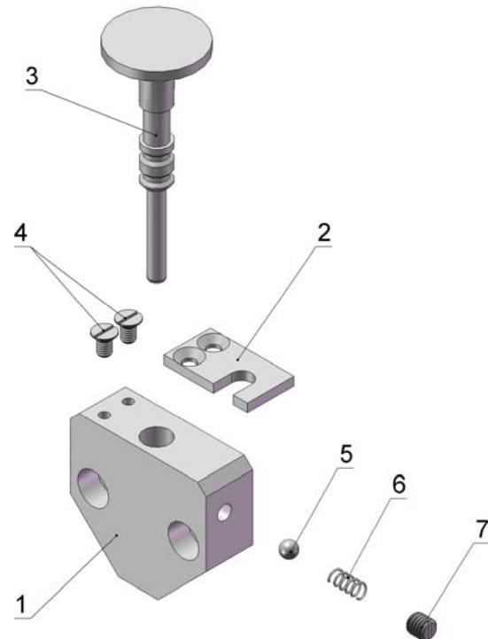
Рис. 4. Механизм замыкателя автоподачи в сборе
