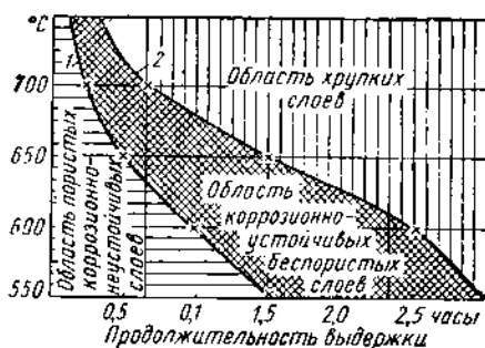
Фиг. 26. Технологические режимы антикоррозионного азотирования (медленное охлаждение после азотирования; при охлаждении в масле кривая 2 сдвигается вправо).
